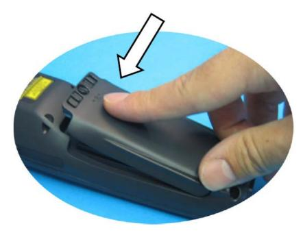
5. Для фиксации крышки передвиньте зажимы от винта, который также необходимо повернуть в горизонтальное положение.
