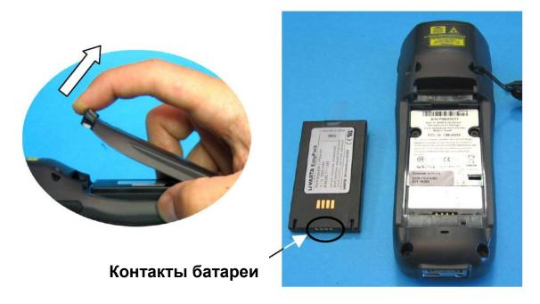
4. Установите новую аккумуляторную батарею, затем положите крышку отсека, в первую очередь установив нижнюю сторону крышки, затем верхнюю, как показано на рисунке:
