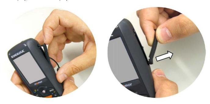
2. Вставьте карту памяти в слот контактами вниз, как показано на рисунке. Затем, помогая задним концом стилуса, нажмите на карту до характерного щелчка для ее закрепления в слоте.
