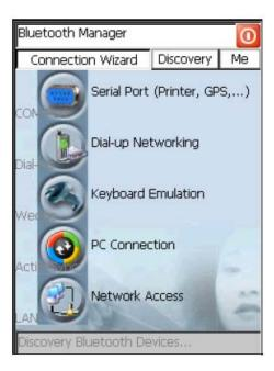
3. Выберите вкладку «Me» и нажмите кнопку «ON» для активизации Bluetooth-модуля. Активизация Bluetooth-модуля также возможна через утилиту «WIRELESS COMMUNICATION» (см. раздел «Беспроводные подключения»).
