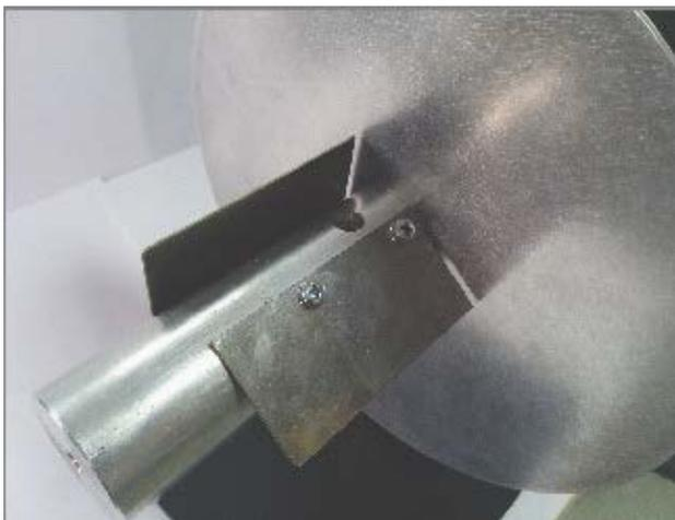
2. Посадка картонной втулки на шпиндель с пластинами-адаптерами должна быть скользящая и не требующая чрезмерных усилий при надевании или снятии. Пластины имеют увеличенные крепежные отверстия, что позволяет выполнить регулировку посадочного размера в небольших пределах.
