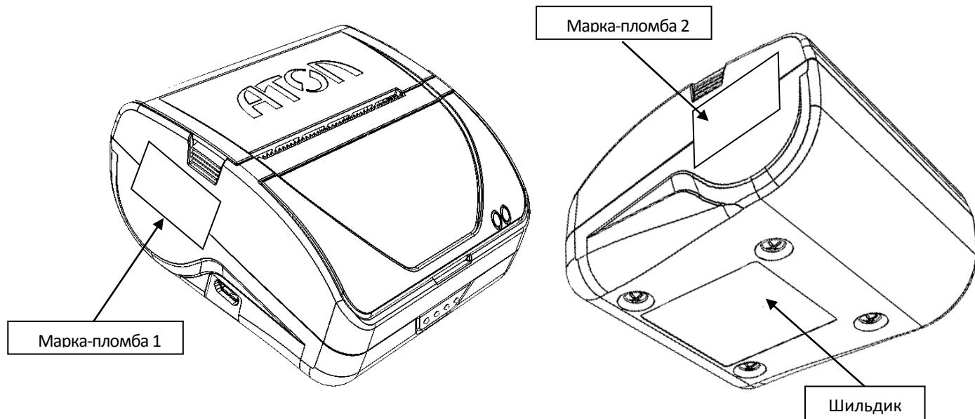
Два элемента марки-пломбы с надписью ККТ наклеиваются на кожух с двух сторон согласно рисунку. Шильдик наклеивается на дно корпуса ККТ.
