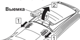
3. Загрузить аккумулятор (HA-F20BAT) или аккумулятор большой емкости (HA-F21LBAT). Позаботьтесь о том, что аккумулятор ориентированный правильно, когда вы загрузите его. Кроме того, когда загрузите аккумулятор, в то время, убедитесь, что конец аккумулятора удаления ленты выступающий над аккумулятором.
