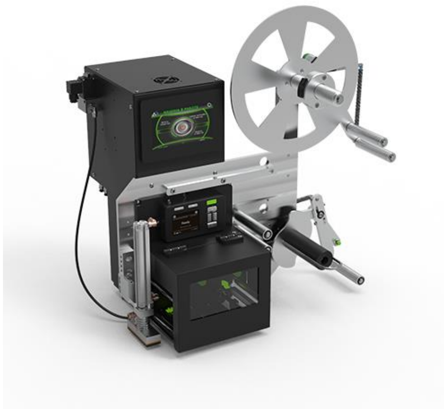
Рисунок. Принтер-аппликатор Н-ПР-01.150-ПН в сборе.
