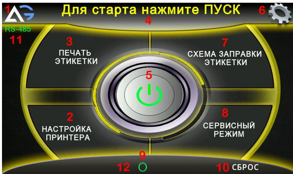
Рисунок. Основное меню принтера-аппликатора Н-ПР-01.
