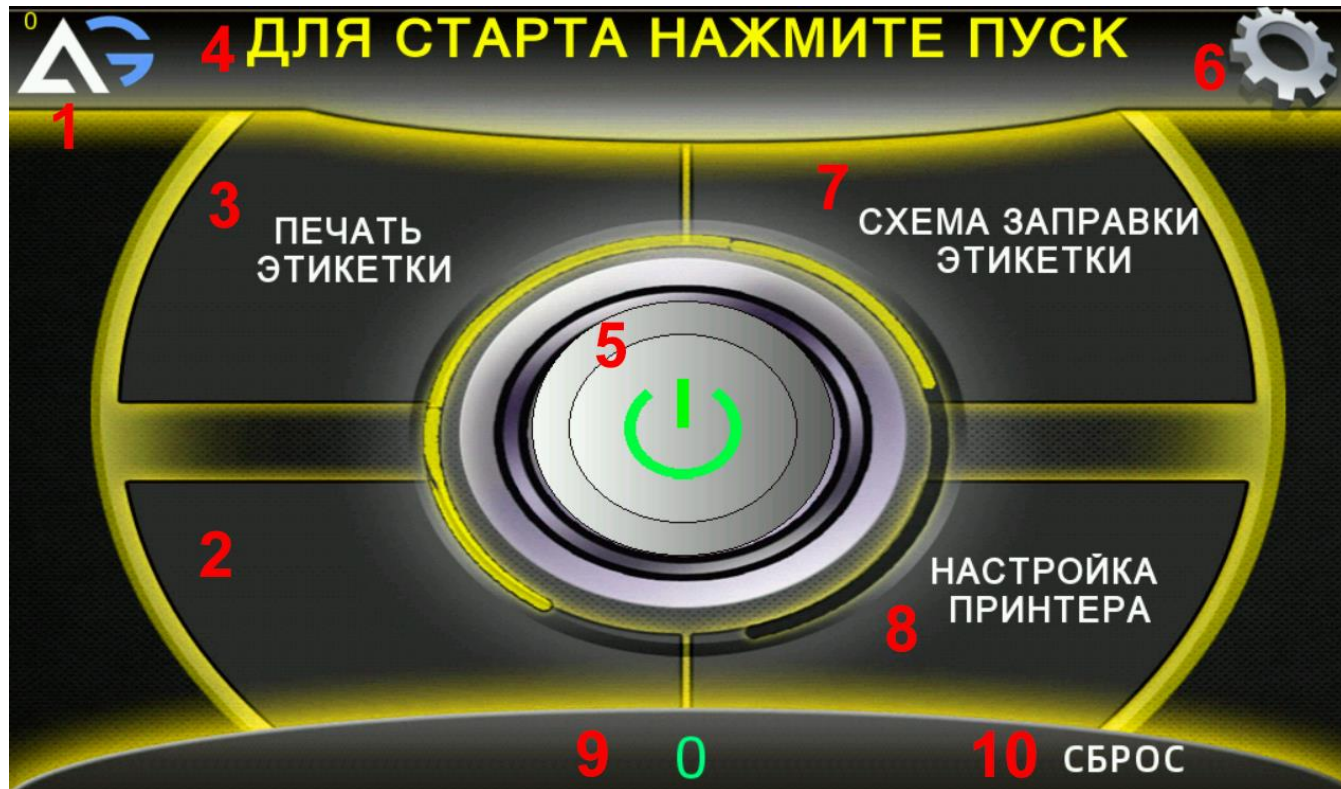
Рисунок. Основное меню принтера-аппликатора Н-ПР-04.
